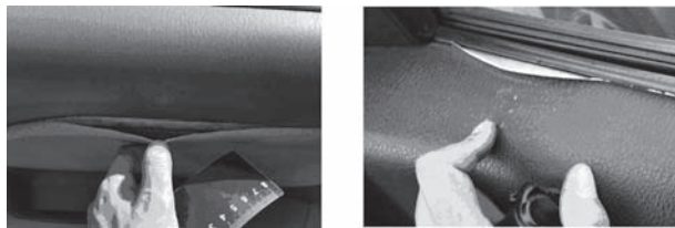
图3 汽车内饰门板的层压材料剥离脱落实物照片
